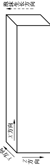
图 2 间歇预制成型聚氨酯泡沫三维方向示意图
