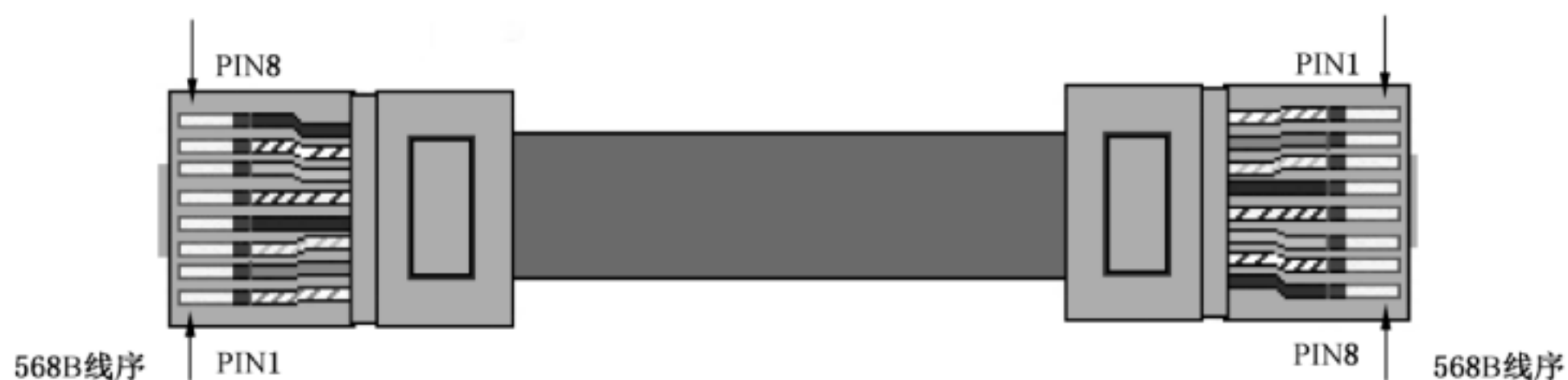
图 6 以太网直通线定义
