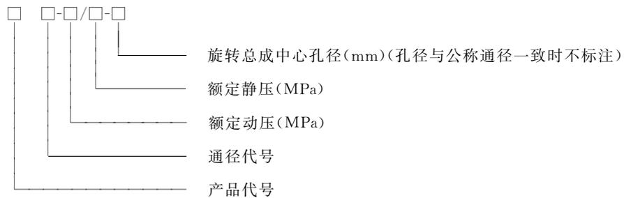
示例 1: XK35-10.5/21-182, 表示被动型旋转防喷器, 公称通径 346 mm, 最大动密封压力 10.5 MPa, 最大静密封压力 21 MPa, 旋转总成中心孔径 182 mm。
