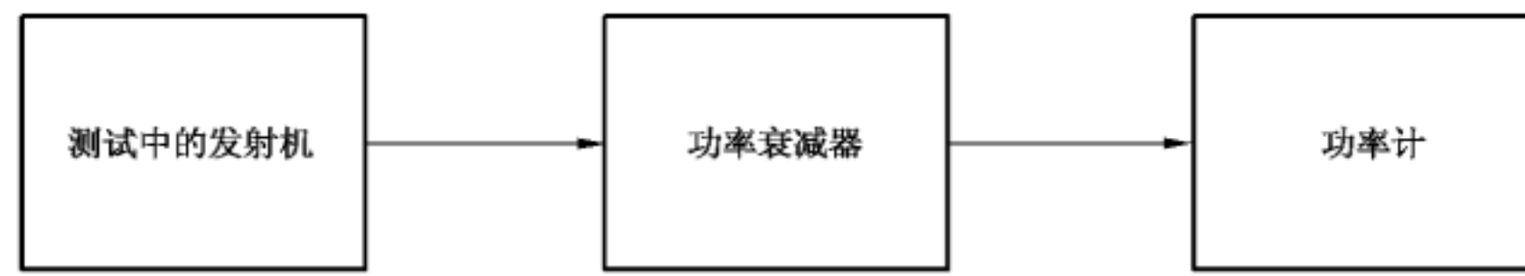
图9 载波功率的测试连接图
