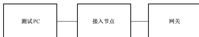
图 3 防端口扫描测试配置
