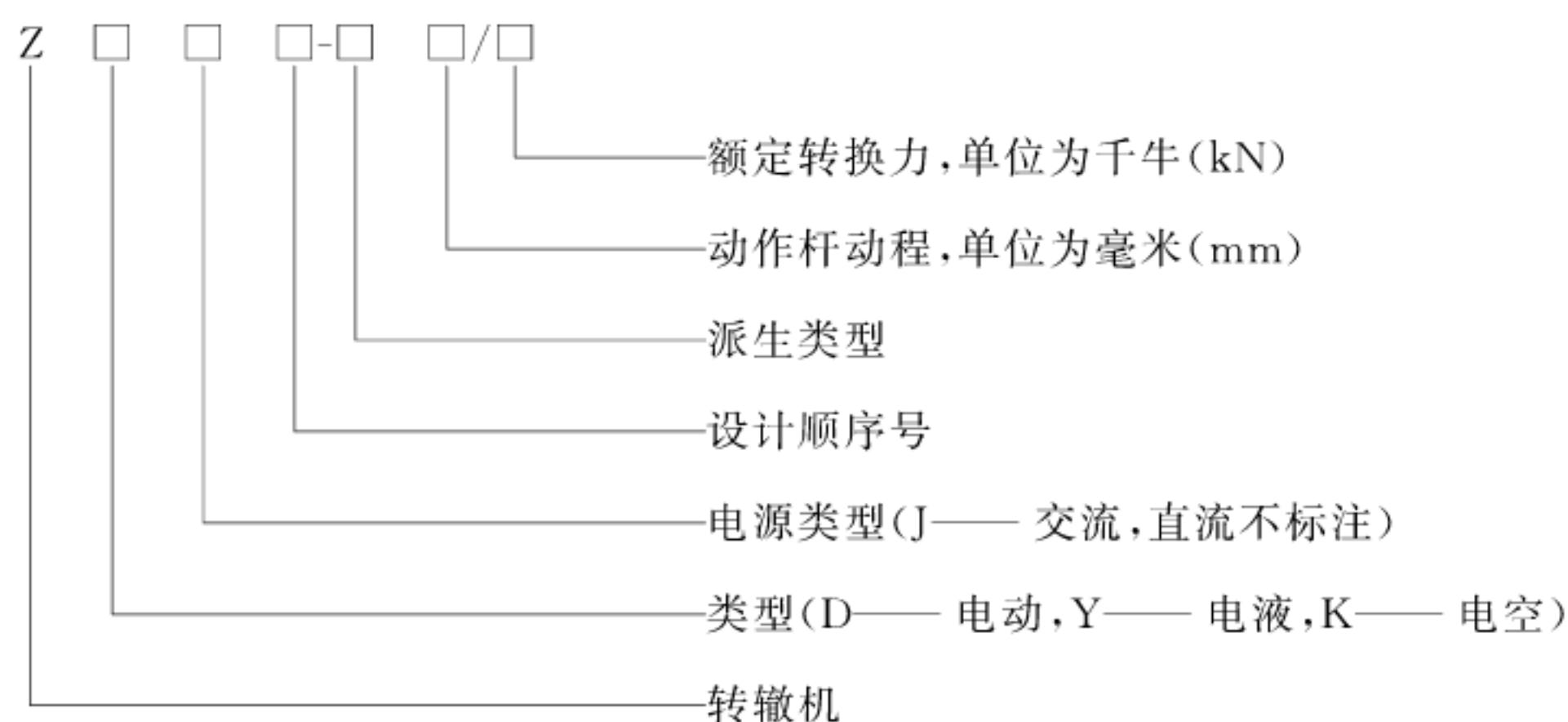
示例 1: 额定转换力为 2.5 kN, 动作杆动程为 220 mm, 派生类型为 A 的电动转辙机表示为 ZD9-A220/2.5。
